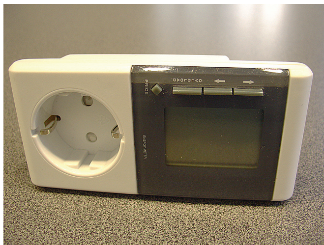
Pistikupesaarvesti, millega saab tavatarbija elektrienergia kulu mõõta
